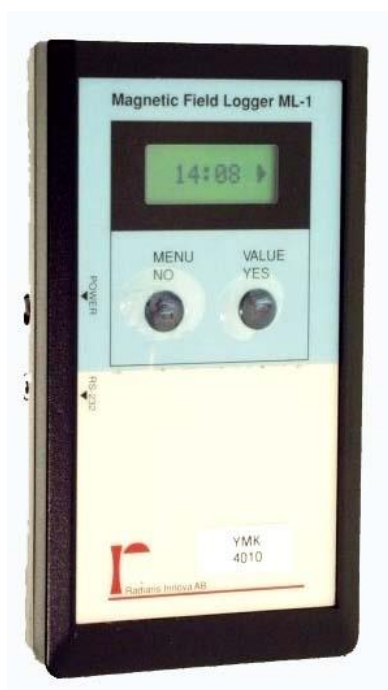
Figur 1. Mätinstrument ML-1 från Radians Innova.
