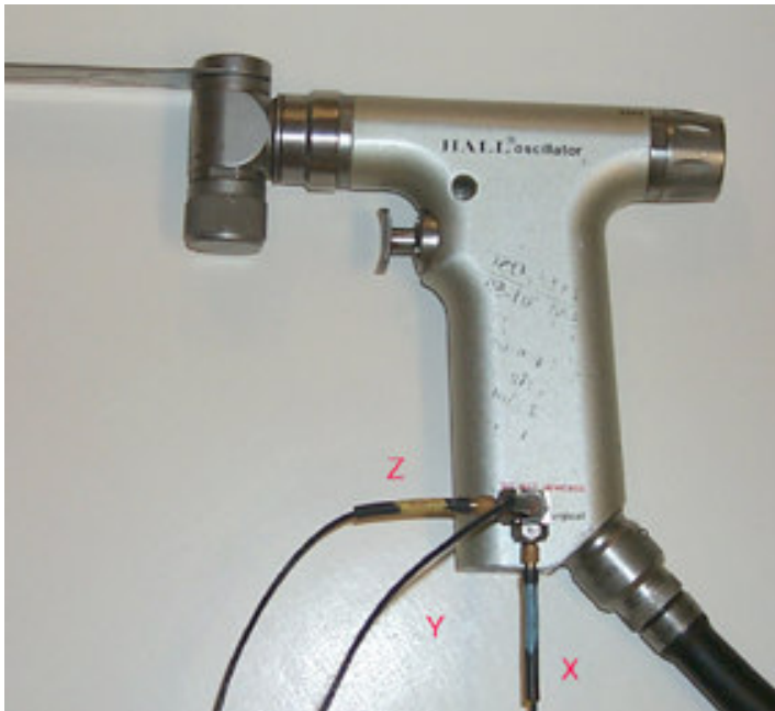
Figur 7 Givarmontaget och de tre huvudriktningarna X_h , Y_h , Z_h för kirurgsågen HALL OSCILLATOR 5044.
