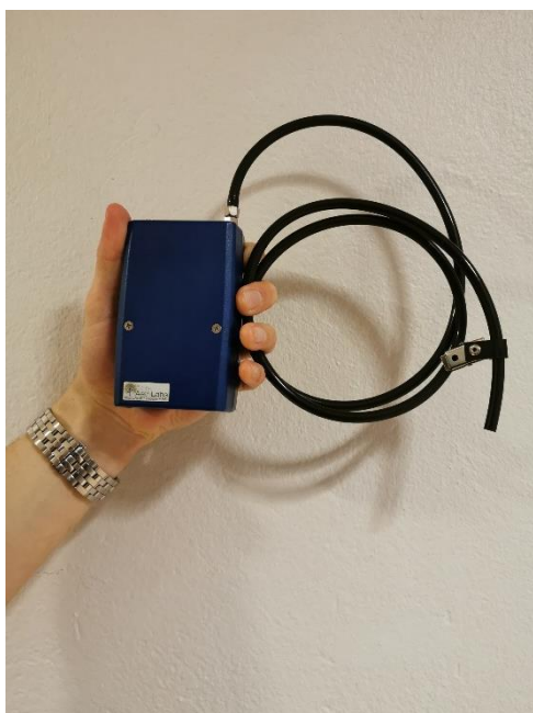
Figur 2 a. Mätinstrumentet microAeth® AE51 som använts i projektet.
