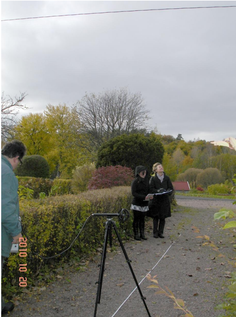
Bild: Mätning av magnetfält med ökande avstånd från kraftledningen.
