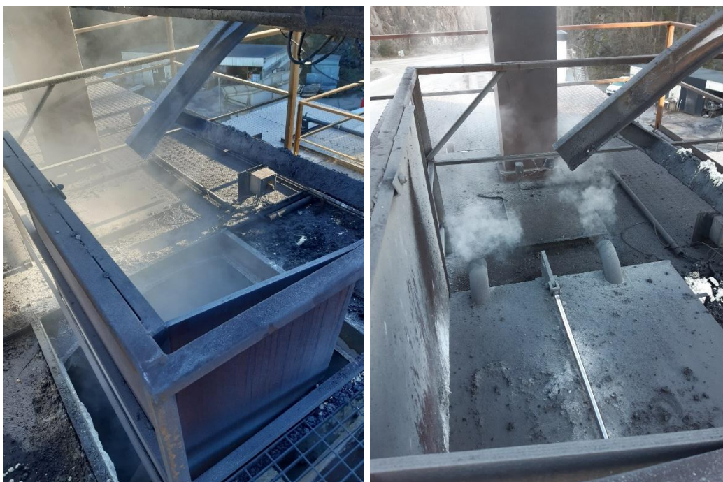
Bild 1. Rök från mixern med locket öppet (vänster) respektive med locket stängt (höger).
